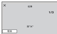
③ 以“Memory Stick PRO Duo”的角或類似物品觸碰顯示幕上顯示的“×”3 次。觸碰 [取消] 取消。
